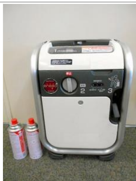
一般的な自家発電機の例。カセットボンベ入りの LP ガスで動かし、人工呼吸器のバッテリーを充電する＝東京都八王子市提供
